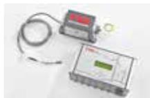
I contatori di particelle di questo tipo possono essere utilizzati per determinare l'usura in una fase iniziale di riduttori industriali fortemente sollecitati sulla base di presenza di particelle metalliche nell'olio.
