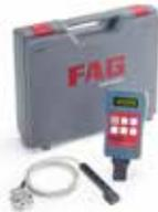
Il TRUMMY2 Top-Laser FAG, robusto e maneggevole, è un sistema ottico - elettronico di misurazione della tensione delle cinghie di trasmissione. Il corretto tensionamento delle cinghie è un prerequisito essenziale per raggiungere la massima durata della stessa. Inoltre, questo riduce anche l'usura dei componenti della trasmissione ed i costi energetici.
