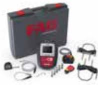
Il FAG Top-Laser EQUILIGN è un sistema di allineamento per alberi, siano essi accoppiati o disaccoppiati in motori, pompe, ventilatori e riduttori con cuscinetti a rotolamento. Semplicità di utilizzo. Visualizzazione in tempo reale degli spostamenti e posizione reciproca delle macchine. Molteplici funzioni, reportistica stampabile. Sistema multilingua. Interfaccia PC via USB.
